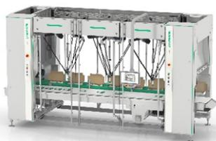
Jede Roboterzelle der RPP Plattform lässt sich individuell konfigurieren, um Prozesse wie Handling, Zuführung und Beladung zu automatisieren.
