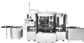
Syntegon hat mehr als 40 Jahren Erfahrung in der Entwicklung und Herstellung vollautomatischer visueller Inspektionsmaschinen für alle flüssigen Pharmazeutika und Packmittel.
