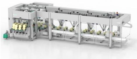
Das kamerabasierte Vision-System der Delta Roboterzellen erkennt die Ausrichtung der Produkte auf dem Zuführband selbst in ungeordneter Reihenfolge.
